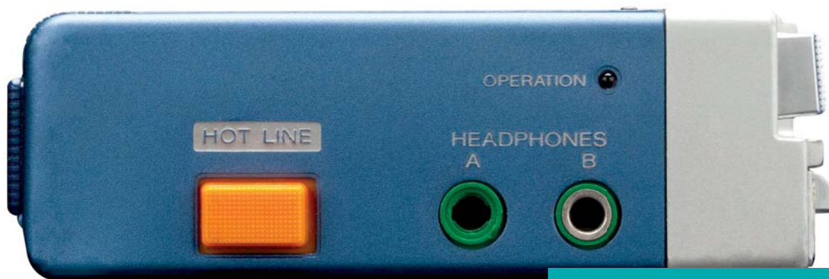
Detalhe do Walkman Sony TPS-L2, que era estéreo e possuía duas saídas para fone de ouvido
