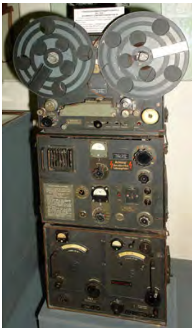
Estação transmissora e receptora alemã transportável e completa, consistindo de um transmissor/receptor Tipo-K e de um gravador de fita Tonschreiber Modelo B.
