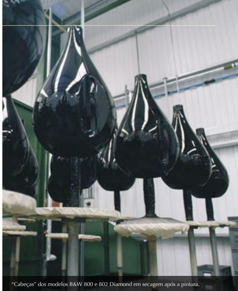
"Cabeças" dos modelos B&W 800 e 802 Diamond em secagem após a pintura.
