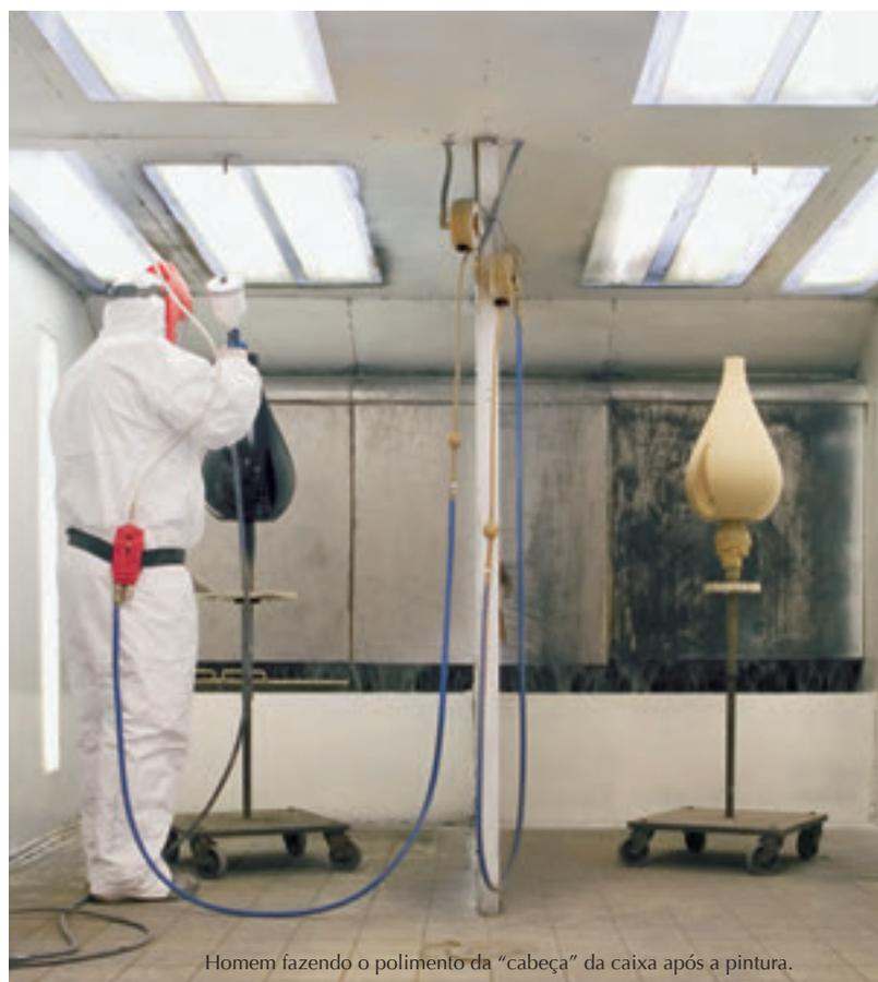
Homem fazendo o polimento da “cabeça” da caixa após a pintura.
